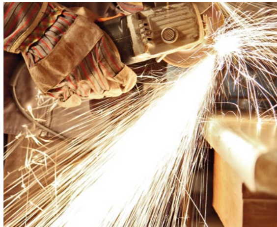
Mechanische Funken und Flammen sowie heiße Gase tragen genug Energie in sich, um eine explosionsfähige Atmosphäre zu entzünden. Das lässt sich durch entsprechende Maßnahmen verhindern.
