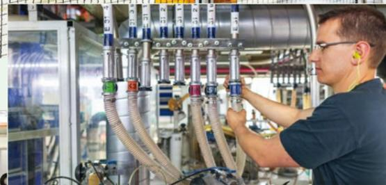
oben: Laut und heiß: Die Blasfolienextrusion ist eine der Basistechnologien von Infiana. Hier wird heißes Polyethylen mit einer Temperatur von 150–250 °C unter hohem Druck verarbeitet. Unten: In der Druckabteilung sind Sauberkeit und Präzision oberstes Gebot.
