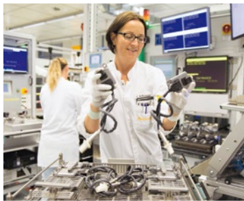
Produktionsmitarbeiterin führt Sichtkontrolle von Verguss bei NOx-Abgasensoren durch.
